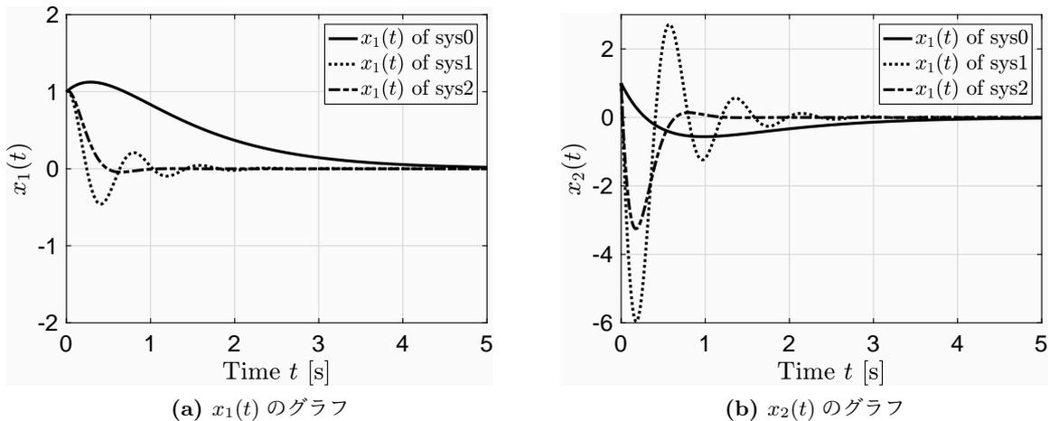
図 2: 開ループシステム, 閉ループシステムの応答
