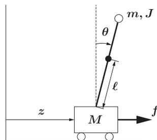
図 1: 倒立振り子 (図中の文字は見やすくするため太文字で表しているが，いずれもスカラーである)
